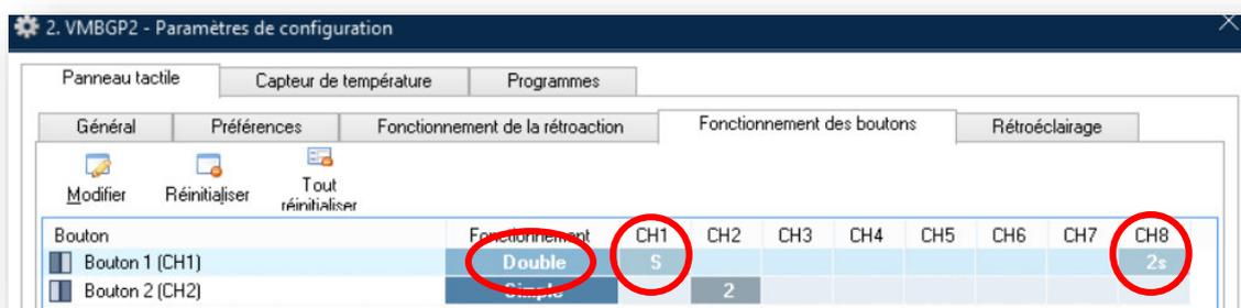
Après avoir fermé la fenêtre de configuration, une icône s'affiche dans la fenêtre de navigation à côté du canal à fonction Double. Changez le nom de Bouton 1 en « L couloir ».
