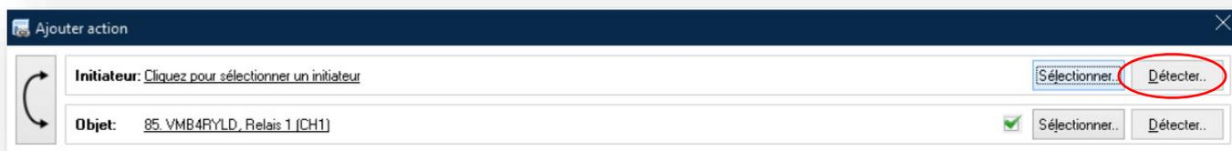
Une fenêtre de dialogue **Détection en cours ...** s'affiche. Appuyez sur un bouton et le canal correspondant s'affichera dans la fenêtre **Détection en cours**. (Si tel n'est pas le cas, vérifiez si les modules corrects ont été sélectionnés dans le filtre, au bas de la fenêtre **Détection en cours ...**)
