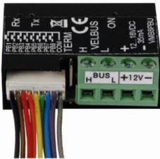
Le VMB8PBU s'installe facilement derrière les boutons-poussoirs de votre choix. Ce module permet de connecter jusqu'à 8 boutons, chacun avec une LED intégrée (disponibles séparément). Les LED peuvent également être activées en mode nuit. Attention : ne rallongez pas les fils reliant les boutons-poussoirs à l'interface.
